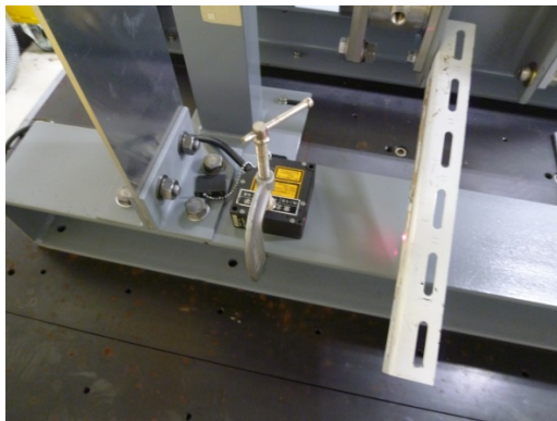
(a) レーザー変位計 (フレーム)
