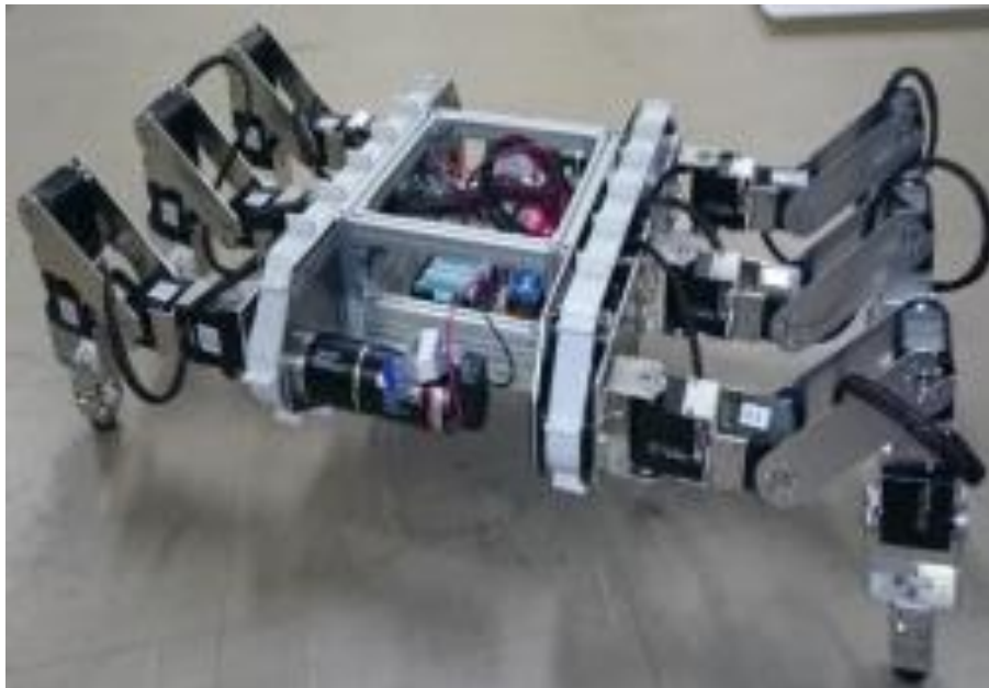
Fig. 1 6 脚クローラ型不整地移動ロボット
