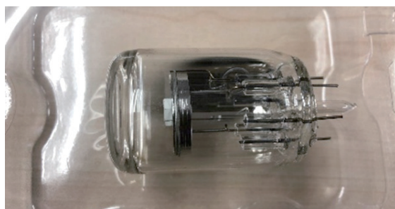
図 6 2020 年度に試作した UV-C 発光型真空管球
