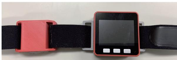
図1 3軸磁気センサ (BMM150) を内蔵した M5Stack FIRE と永久磁石をベルトに固定した呼吸測定器。
