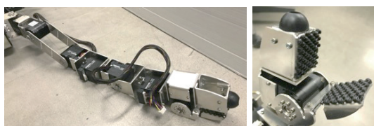
図4. 開発した6自由度脚 (左) とハンド (右)
