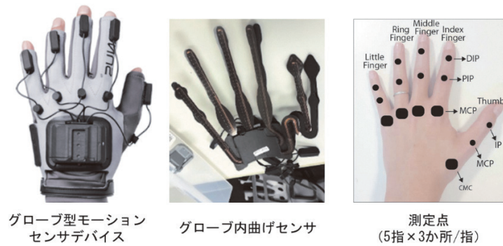
図7：グローブ型モーションセンシングシステムの概要
