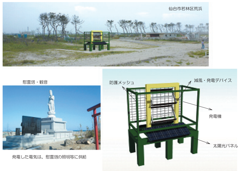
図－8 実証試験装置概要
