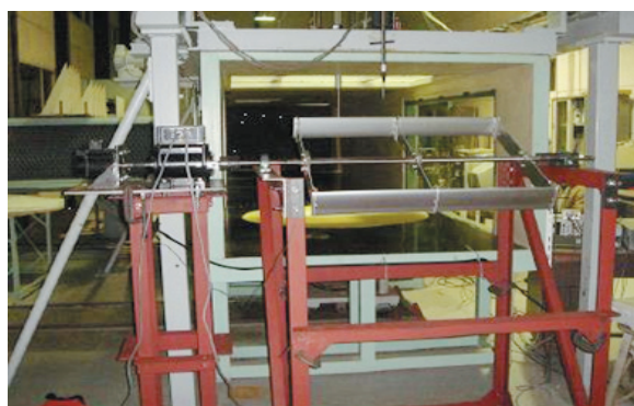
写真-1 減風・発電デバイス性能試験
