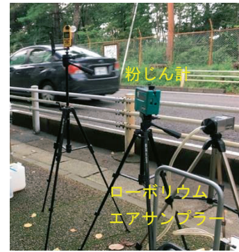
図 2 沿道測定地点への PM 測定機器設置状況
