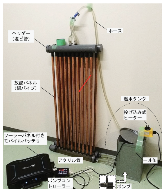
写真-1 暖房パネルシステムの構成
