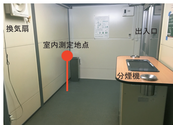
図2(a) 9号館脇喫煙室内部と粉じん濃度測定・捕集地点
