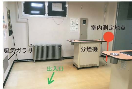
図 4(a) 4号館喫煙室内部と粉じん濃度測定・捕集地点
